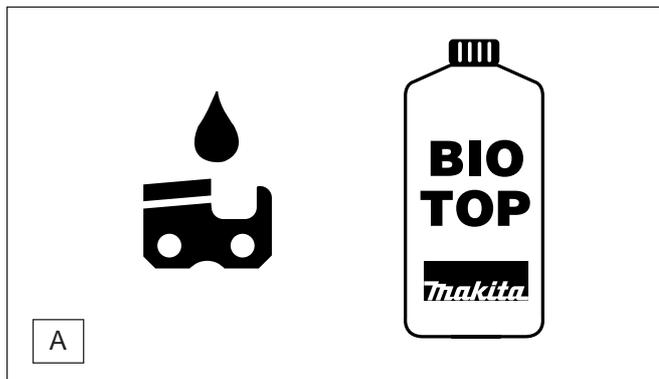
Для смазки пильной цепи и полотна пилы необходимо использовать масло для цепных пил с адгезионной присадкой. Адгезионная присадка в цепном масле препятствует быстрому стравливанию масла с пильного приспособления.
