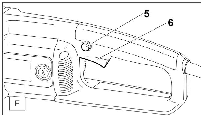
Прежде чем включать электропилу в сеть нужно проверить возвращается ли нажатый переключатель (F/6) ВКЛ/ВЫКЛ после отпускания в положение «выкл.». Если нет, ни в коем случае не включайте электропилу в сеть. Обратитесь в мастерскую МАКИТА.
