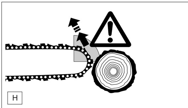
Цепные пилы UC3003A, UC3503A, UC4003A и UC4503A серийно оснащены цепным тормозом, срабатывающим при достижении определённого ускорения. В случае рикошета, возникающего при прикосновении носовой частью полотна цепи к дереву (см. раздел "Указания по технике безопасности" на стр. 7), цепной тормоз срабатывает при достаточно сильном отбрасывании из-за инерционности массы.
