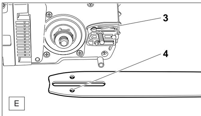
Для обеспечения безупречной работы масляного насоса необходимо периодически очищать маслопроводящий паз (E/3) и маслоподающее отверстие в полотне пилы (E/4).
