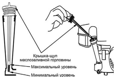
Рис. 7 Проверка уровня масла в картере
